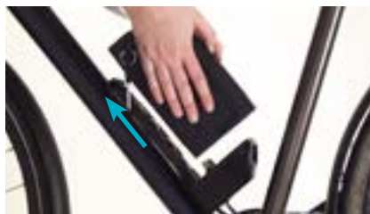
dot. pkt 2. Akumulator wyciągnąć ze stacji
