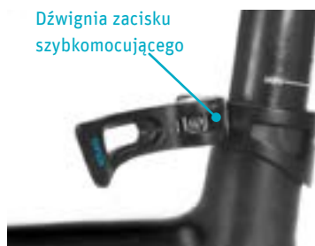
dot. pkt 1. Otworzyć dźwignię zacisku
