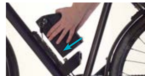
dot. pkt 2. Przytrzymać akumulator przy stacji dokującej
