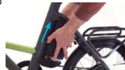
dot. pkt 5. Wyciągnąć akumulator ze stacji dokującej
