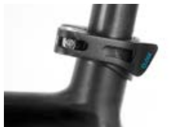
dot. pkt 2. Zamknięta dźwignia zacisku
